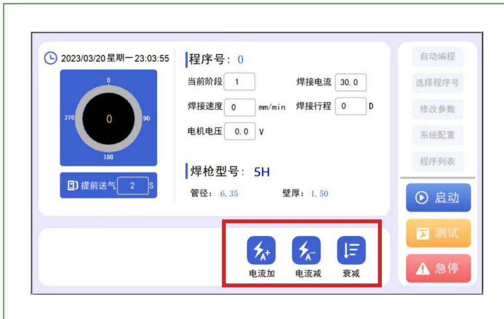
通过上图红框中的功能按钮，来实现对焊机运行中的电流加，电流减，衰减等功能。
